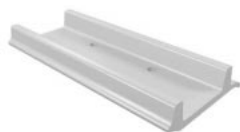
① Башмаки с двойным грунтозацепом
