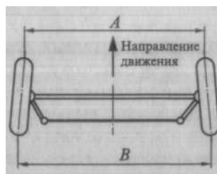
Рис. 9.36. Установка направляющих колес
