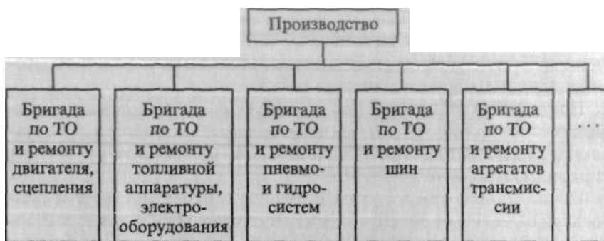
Рис. 6.4. Структура производства при использовании агрегатно-участкового метода
